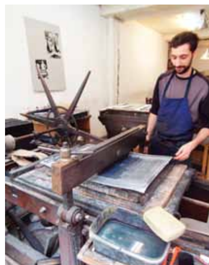
La presse lithographique (remarquez l'épaisseur de la pierre, sous la feuille de papier). Ph. J.-F. Delangle
